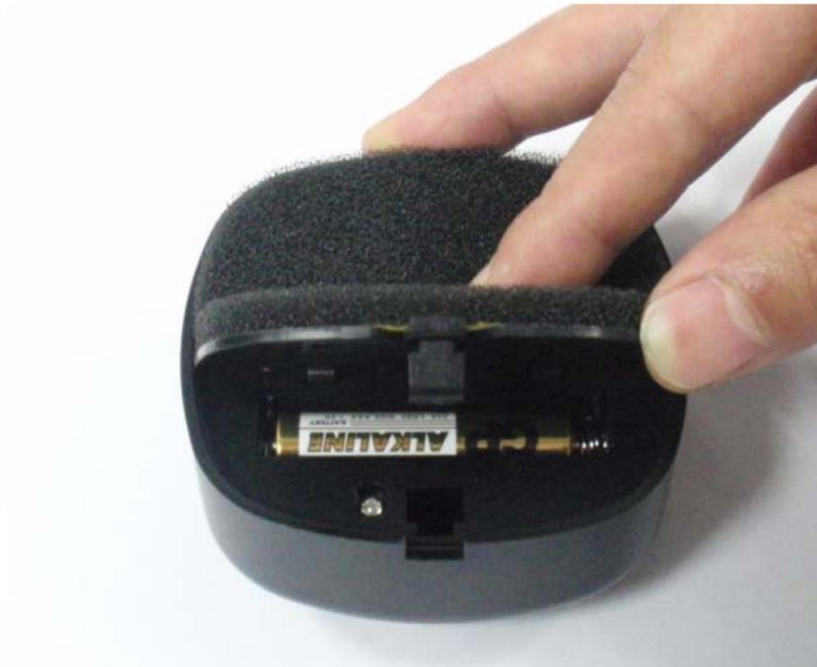
装入电池后，盖紧电池盖，电子板擦就可以使用了。
