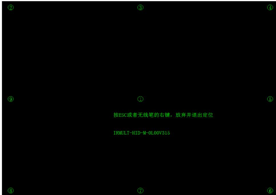
第五步：用白板笔点住闪烁的“十”字光标的中心不动，直至闪烁的“十”字光标移动到下一个定位点后松开笔，这样就完成了一个点的定位。根据定位界面中的提示照此方法依次定好其它的定位点，即完成电子白板的定位。
