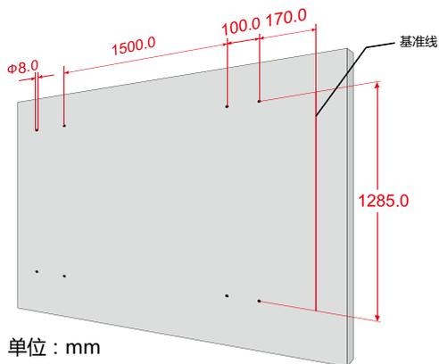
步骤 3: 将 M6\*50 膨胀螺栓敲入墙体, 然后把 4 个挂墙件 B 固定在墙体上。
