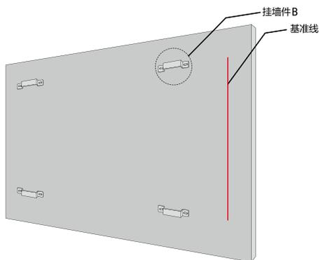
步骤 4: 抬起白板, 使其边缘与墙体上的基准线对齐, 以便将白板上的 4 个挂墙件 A 准确无误地勾住墙上的挂墙件 B 中。
