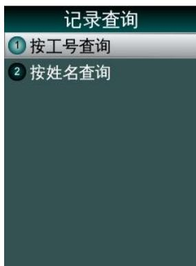
管理员的记录查询，包括按工号查询和按姓名查询两个功能，分别输入工号或姓名，定位相应的用户和日期区间，显示出该用户在指定日期区间内的打卡记录。
