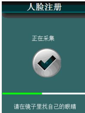
**!** 注意：按照设备提示“请在镜子中找自己的眼睛”，用户靠近设备并注视反光镜，使自己的眼睛定位在镜子中间，保持此位置并轻微调整头部姿势，系统自动提取人脸模板，在显示屏下方显示实际进度，红色指示灯闪。
