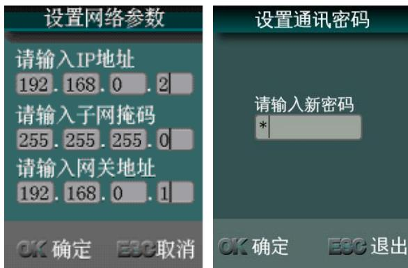
设置网络参数：设置固定 IP 地址，设置本网络的子网掩码，设置本网络的网关。
