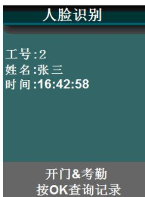
可以查询自己当前、一周、一月、任意日期段和全部记录。用户按 **↑**/**↓** 键浏览记录，按“ESC”退出查询，或 10 秒无操作自动退出查询，回到待机状态。
